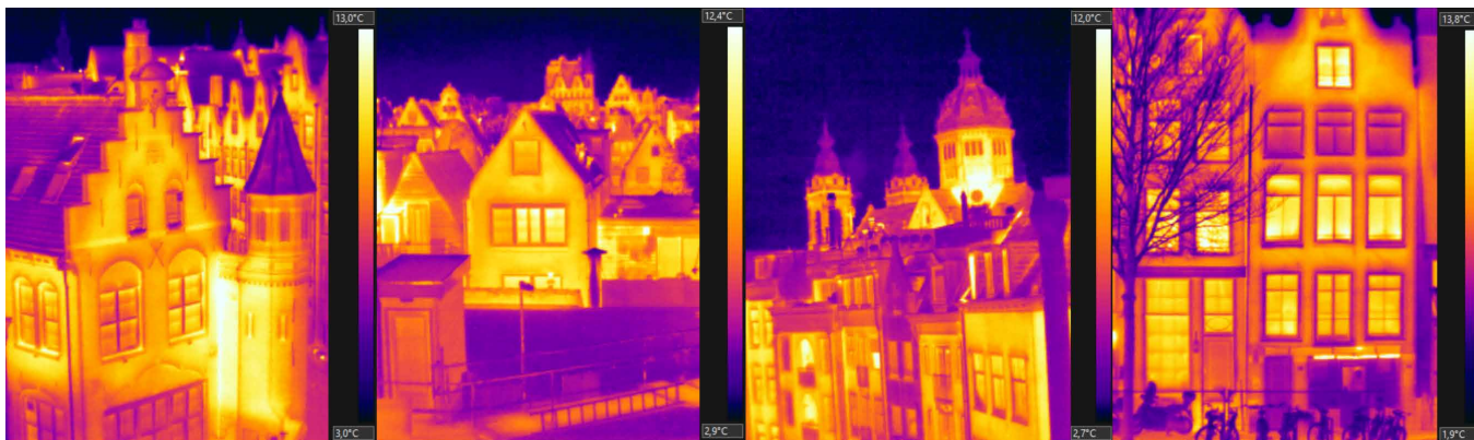
AFB. 8.3 Thermografische foto's van monumentale panden, die zichtbaar maken waar in de schil van gebouwen de grootste energieverliezen optreden (Maéva Dang).
