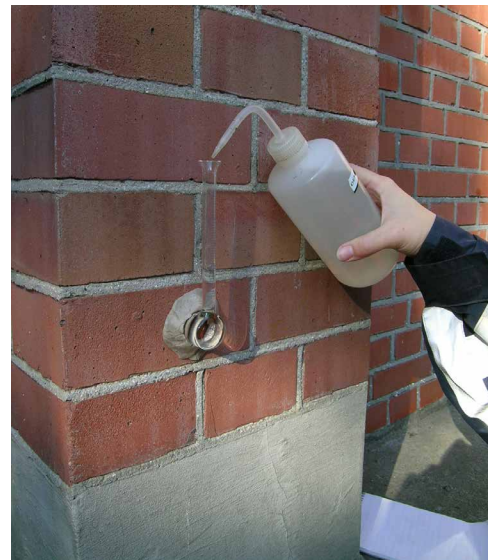
FIG. 4.20 Karsten Tube test / Photo: R. van Hees
