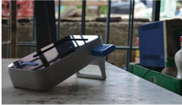
图 5-2 通过指尖采血诊断早期疟疾的光学仪器
